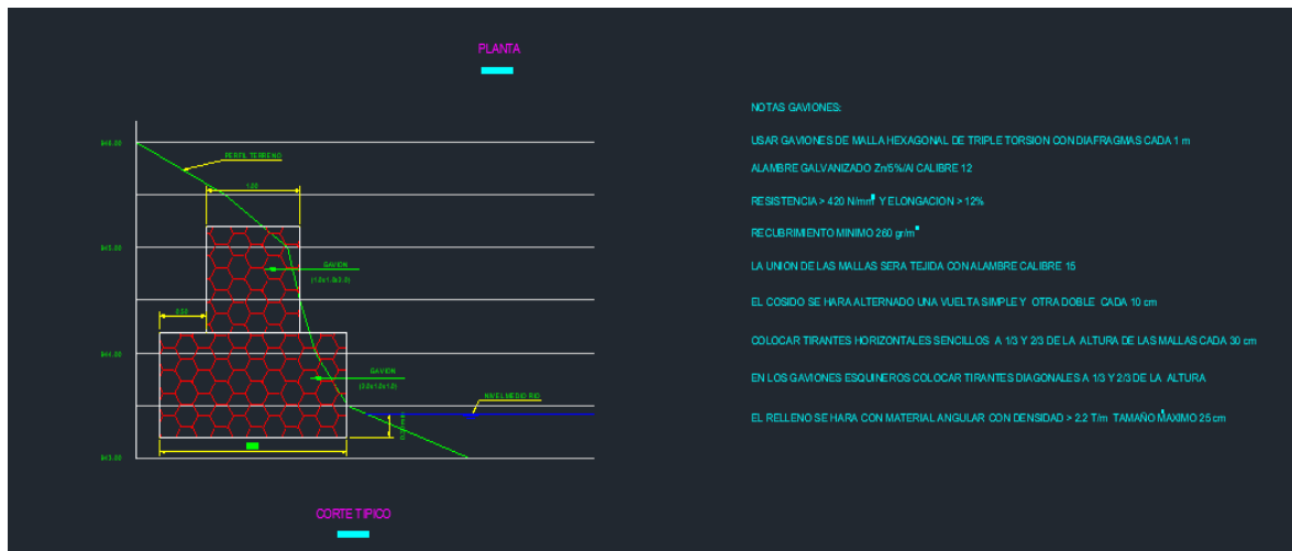
Imagen 11. Detalle obra de estructura de gaviones para el colector final.
