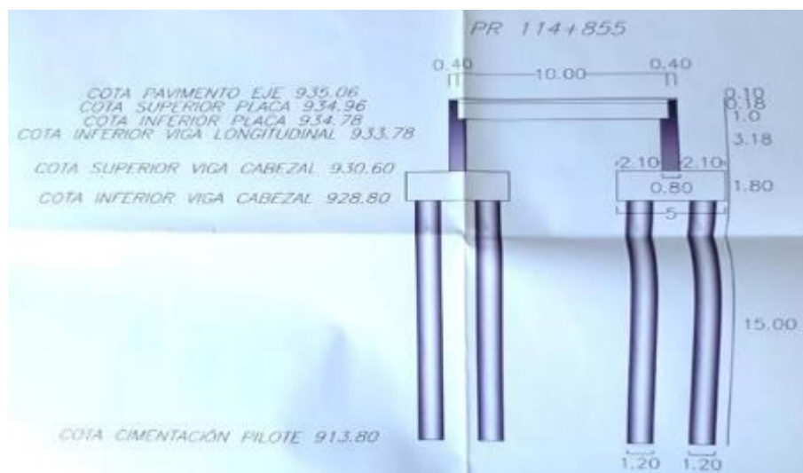
Detalle niveles de cimentación del puente 2: Paso Auxiliar. Fuente INVIAS. (Plano 16 de 17). 2019
