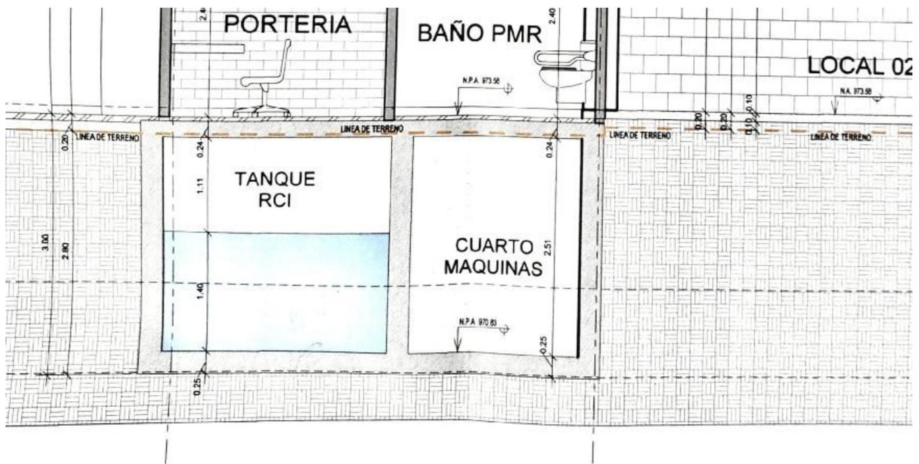
**Ilustración 2.** Corte transversal, tanque subterráneo RCI y cuarto de máquinas.
