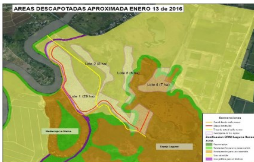
Figura 8. Área del predio Rancho Grande en cada categoría de la zonificación del DRMI Laguna de Sonso y su afectación. Cálculo del área descapotada, reconstruida a partir de las fotografías y videos tomadas con el dron enero 13 de 2016.
