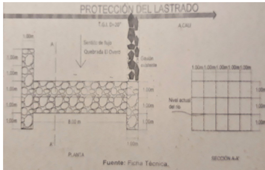
Detalle en planta de la propuesta de reconstrucción de lastrado del gaseoducto. Fuente Transportadora de Gas Internacional S.A. 2020.
