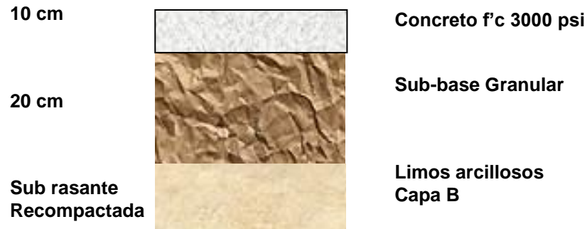
Figura No 10. Alternativa estructura pisos (tráfico liviano)
