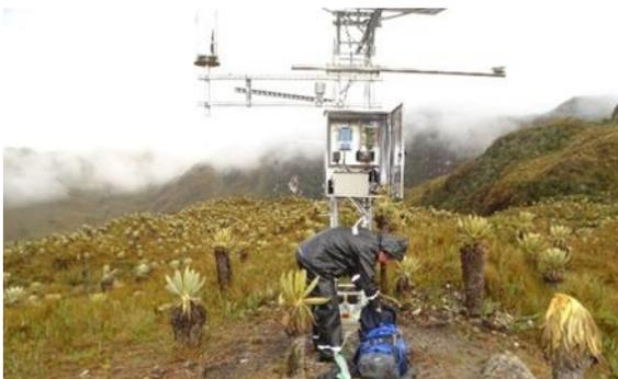
Foto 58. Mantenimiento correctivo estación automática Valle de los Frailejones.
