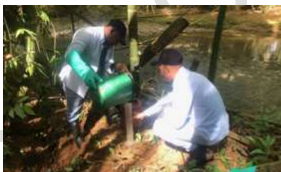
Foto 87. Monitoreo de vertimientos del efluente de una PTAR doméstica. Archivo CVC, 2024
