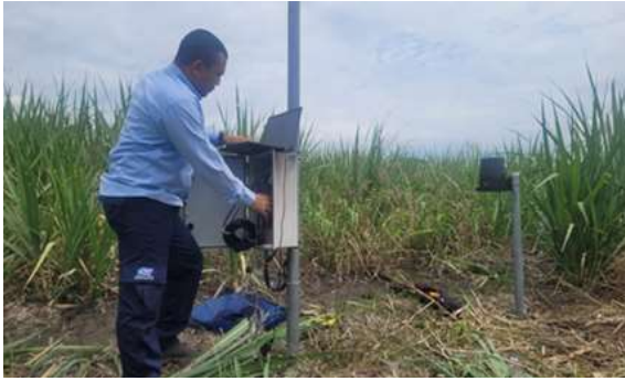
Foto 4. Limpieza y revisión del estado de las estaciones automáticas de calidad del suelo, detalle 1. Archivo CVC, 2024
