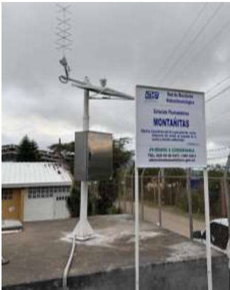
Foto 68. Estación Montañitas con sistema de transmisión satelital. Archivo CVC, 2026
