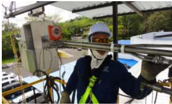
Foto 81. Medición del ángulo inclinación de la sonda durante aplicación del Método 2 US EPA, realizada en chimenea asociada a un horno crematorio, Archivo CVC, 2026.
